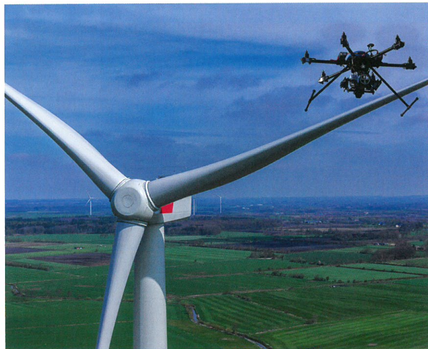
Drohnen können auch für Inspektionsarbeiten an Windenergieanlagen eingesetzt werden. Außer der Bestandsaufnahme sind sogar unterstützende Reparaturarbeiten denkbar.
